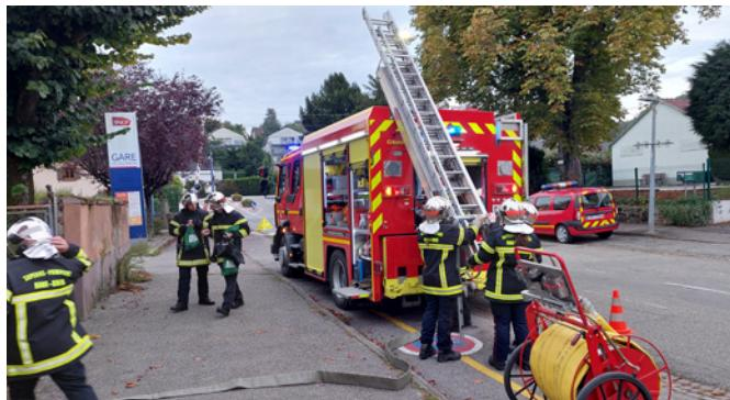
Cette manœuvre a également été l'occasion pour les sapeurs-pompiers de tester leur nouveau véhicule, un fourgon-pompe-tonne de grande puissance. Capable de délivrer jusqu'à 4 000 litres d'eau par minute à une pression de 15 bars, cet équipement répond pleinement aux besoins opérationnels du corps des sapeurs-pompiers.
